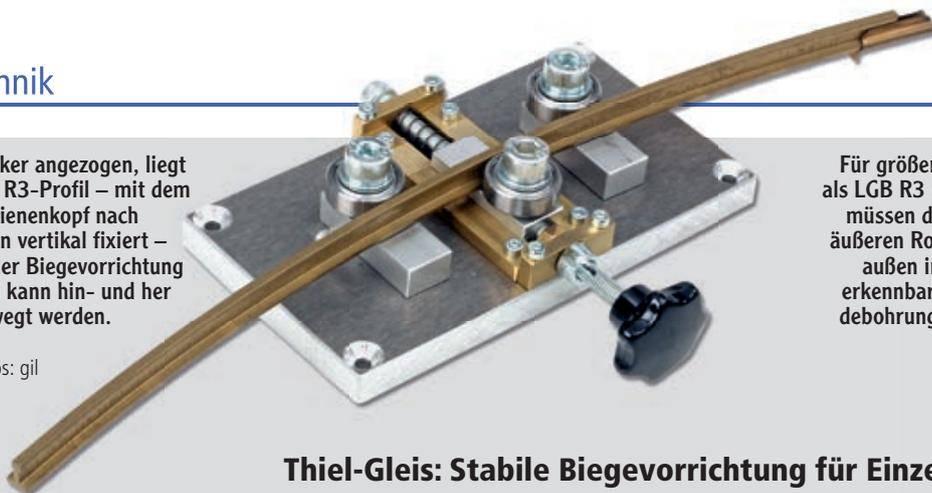
Für größere Radien als LGB R3 (120 cm) müssen die beiden äußeren Rollen nach außen in die hier erkennbare Gewindebohrung versetzt werden.
