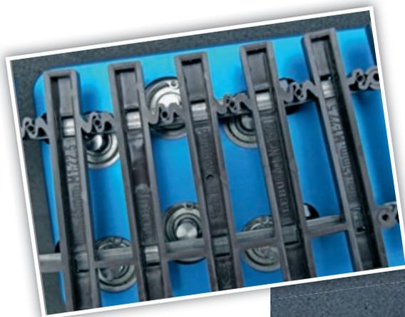
Die Rollen setzen am Schienenkopf an und sind so konstruiert, dass die meisten geschraubten Schienenverbinder überfahren werden können. So lassen sich verbundene Flexgleise an einem Stück biegen.
