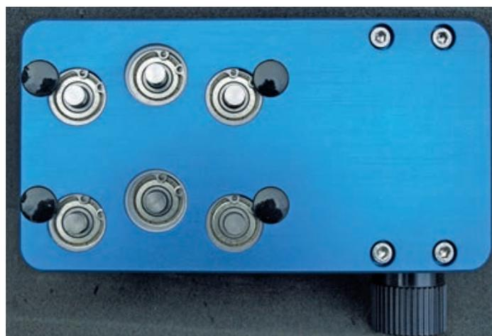
Auf vier Kunststoffstößeln gleitet der Schlitten über die Schienenköpfe.
