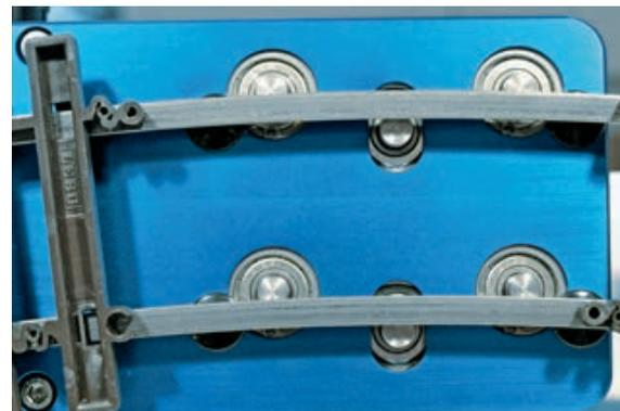
Erste Biegeversuche, hier noch am Vorserienmodell vorgenommen: Im Bild links liegen die Profile des Lebu-Flexgleises nicht an den Rollen an, das Bild rechts zeigt sie anliegend während des Biegevorgangs.
