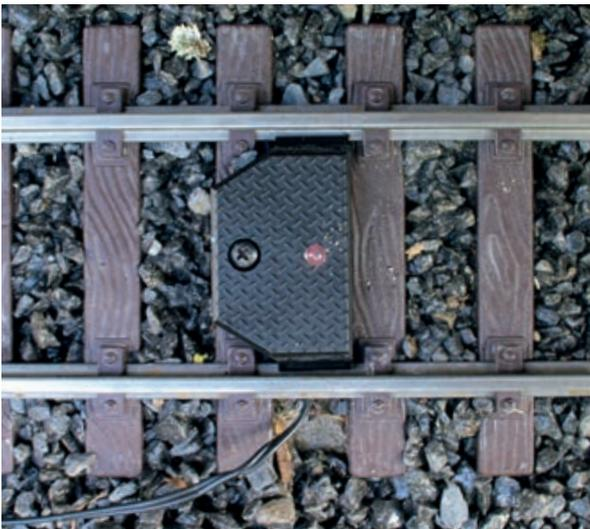
So wird der PZB-Sender im Gleis verbaut; im Bild erkennt man am leichten Rotton der LED, dass diese in Betrieb ist.
