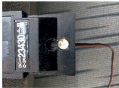
Getriebebodenplatte aus dem Drehgestell einer Ge4/4 II (LGB #2043 ff.) mit Bohrung für LED (links) und eingesetzter LED (rechts).
