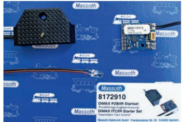
Das wird geliefert: Verpackung des PZB/IR-Startsets mit Inhalt.
