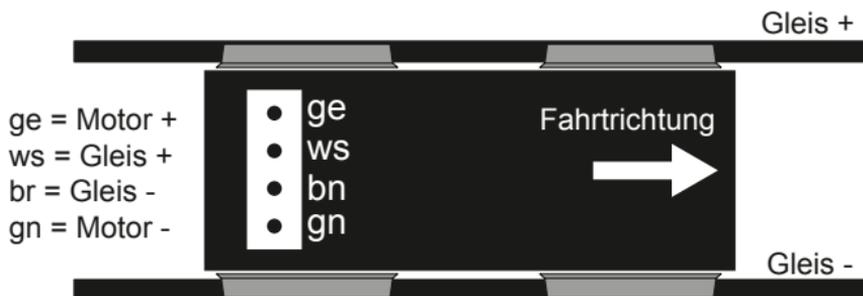
Abbildung 2: Anschluss an ein LGB Getriebe
