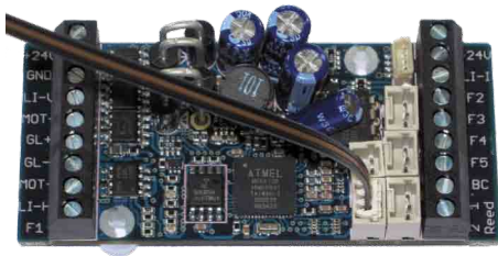
Abbildung 1: Anschluss an Taktgeberbuchse des XLS-Decoders
