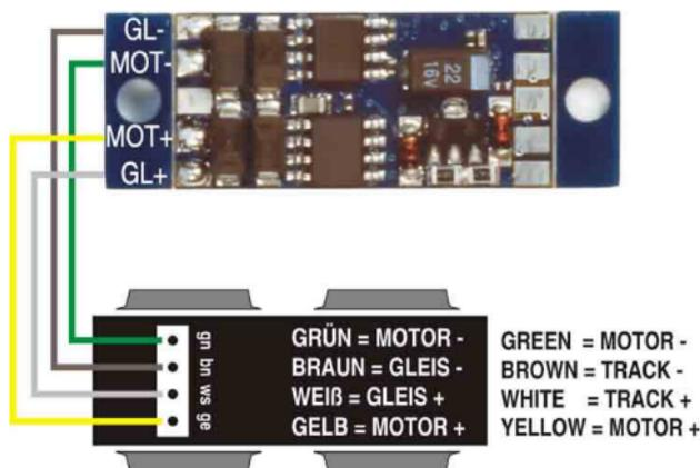
Abbildung 4: Anschluss am LGB® Getriebe
