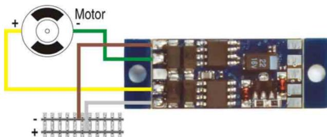
Abbildung 1: Anschluss an Motor + Gleis
