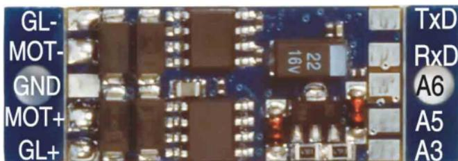
Abbildung 3: eMOTION Dekoder Anschlüsse auf der Unterseite
