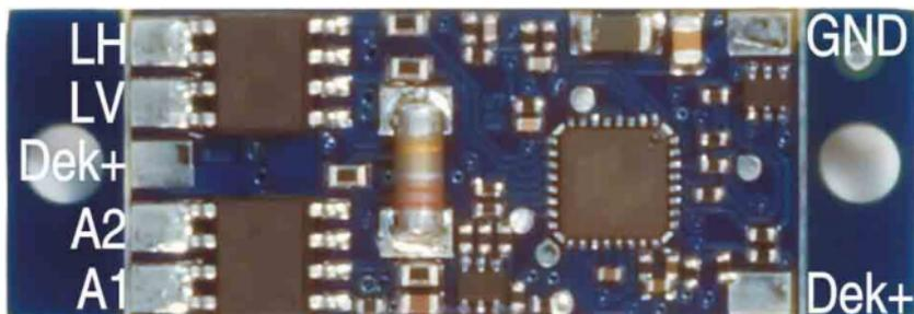
Abbildung 2: eMOTION Dekoder Anschlüsse auf der Oberseite
