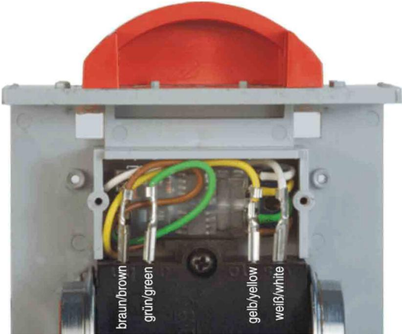
Abbildung 5: Anschluss am Feldbahn Getriebe
