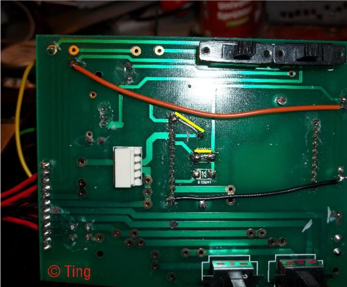
Auf der Oberseite werden die mit X gekennzeichneten Bauteile entfernt und 3 Leiterbahnen durchtrennt.
