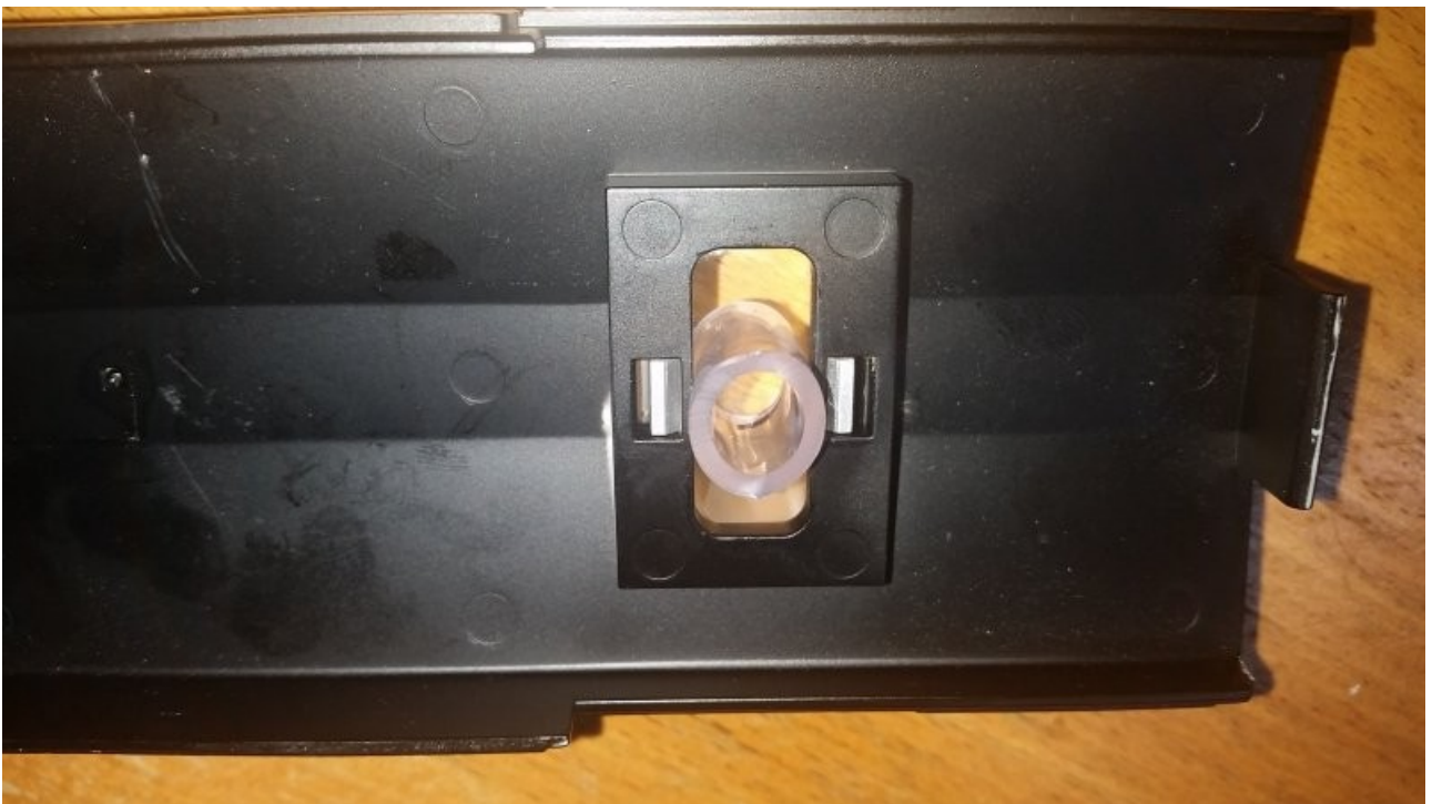
Bild-5: Einsetzen des Schlauchs
