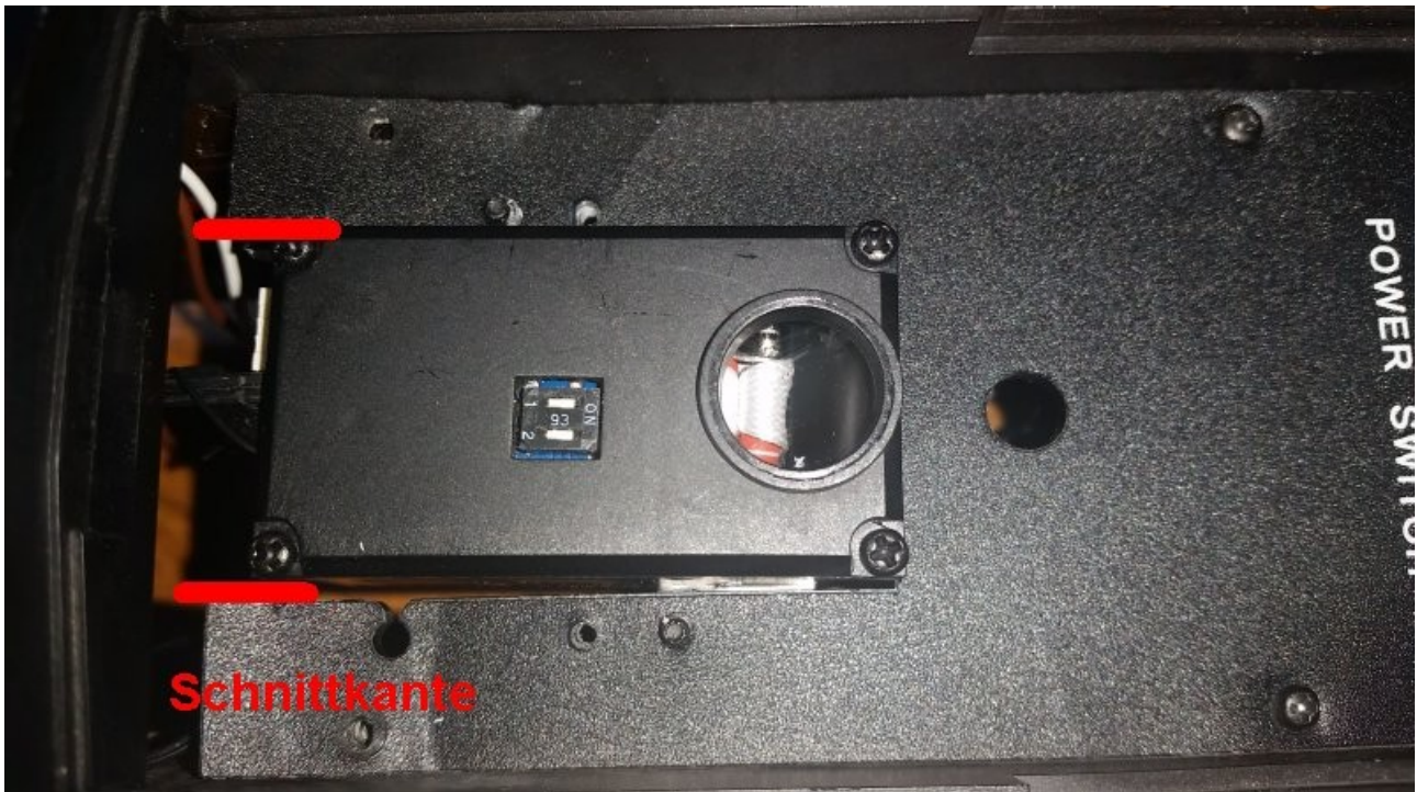
Bild-4: Modifizierung der Elektronikhalterung
