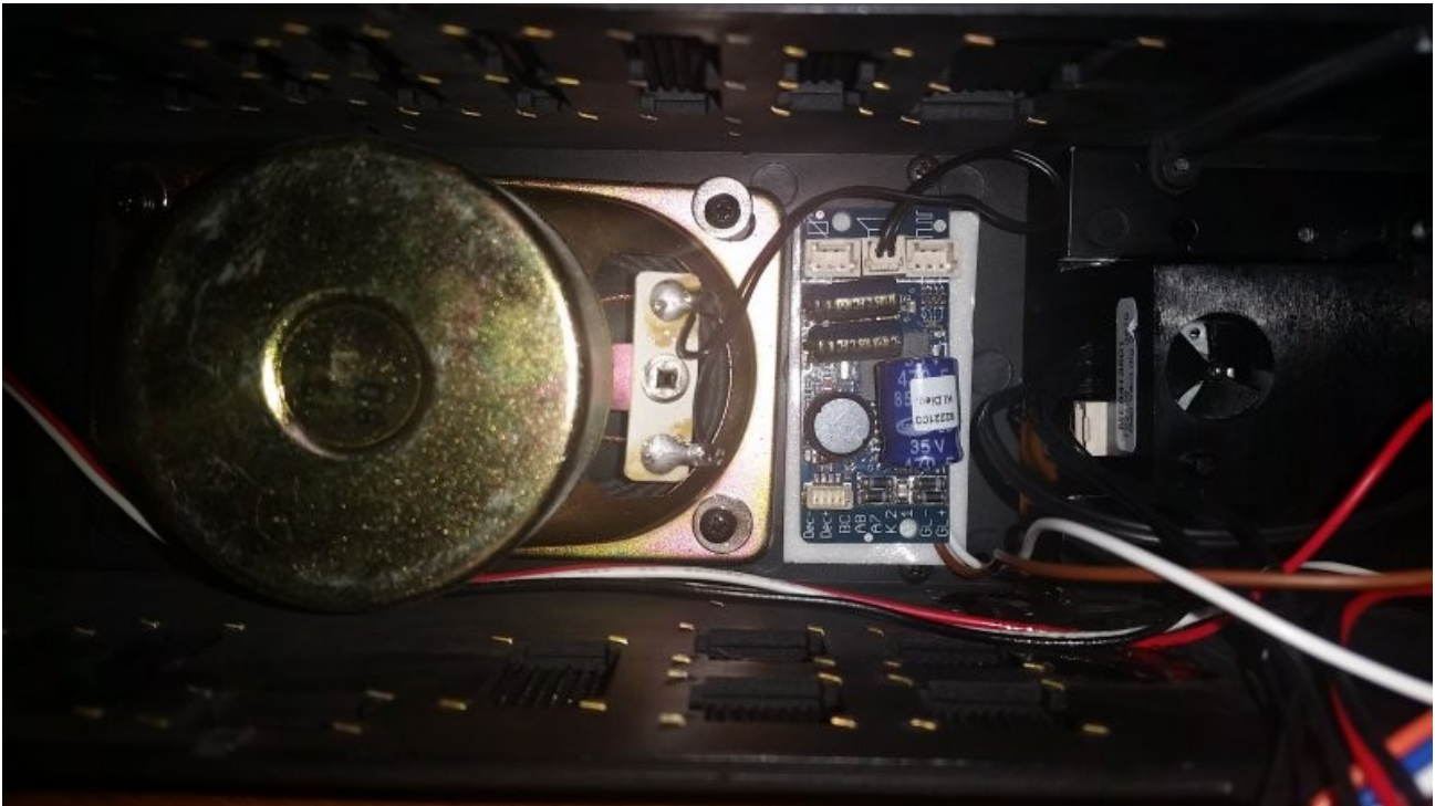
Bild-6: Montage des S-Decoders
