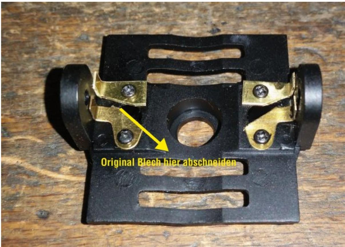
Fertig modifizierte Getriebekblockhalterung
