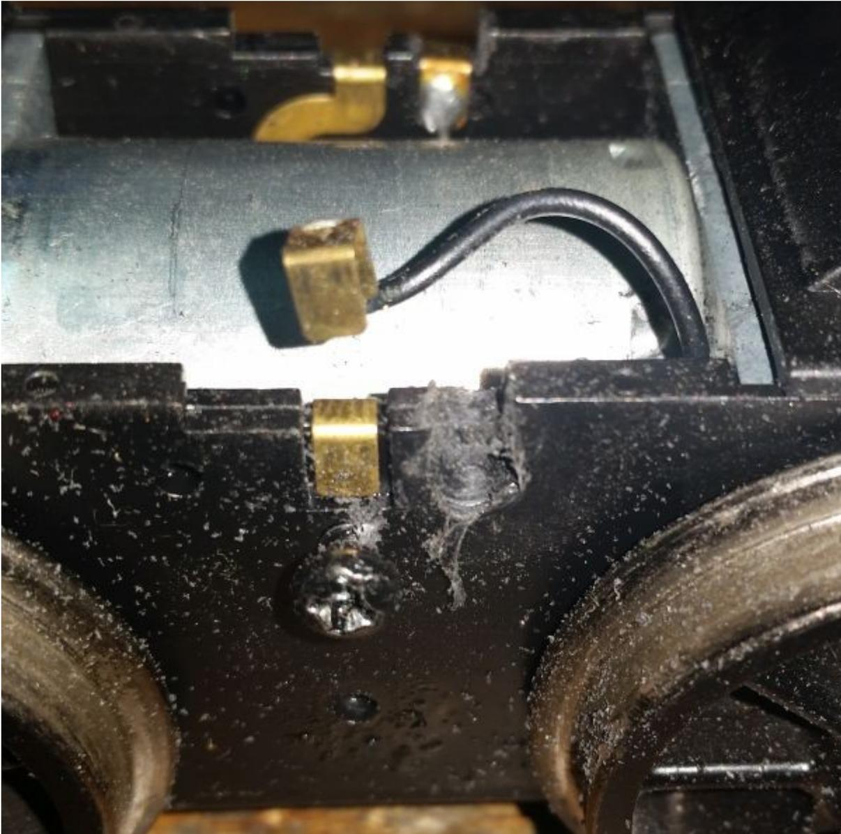
Ausfräsung für Motorkontakt
