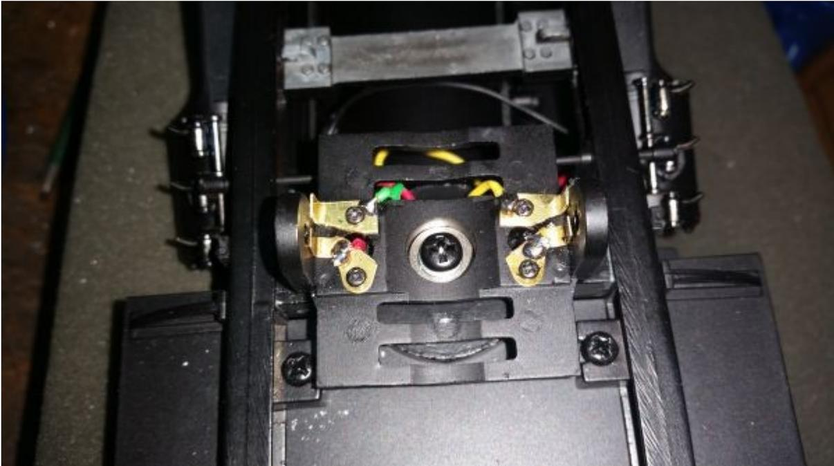
Montierte Getriebelockhalterung mit Anschlüssen
