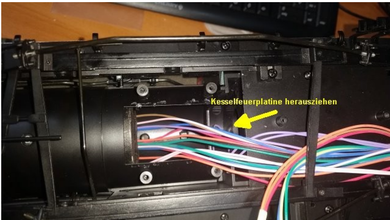
Bild 15: Entfernen des Kesselfeuerreflektors
