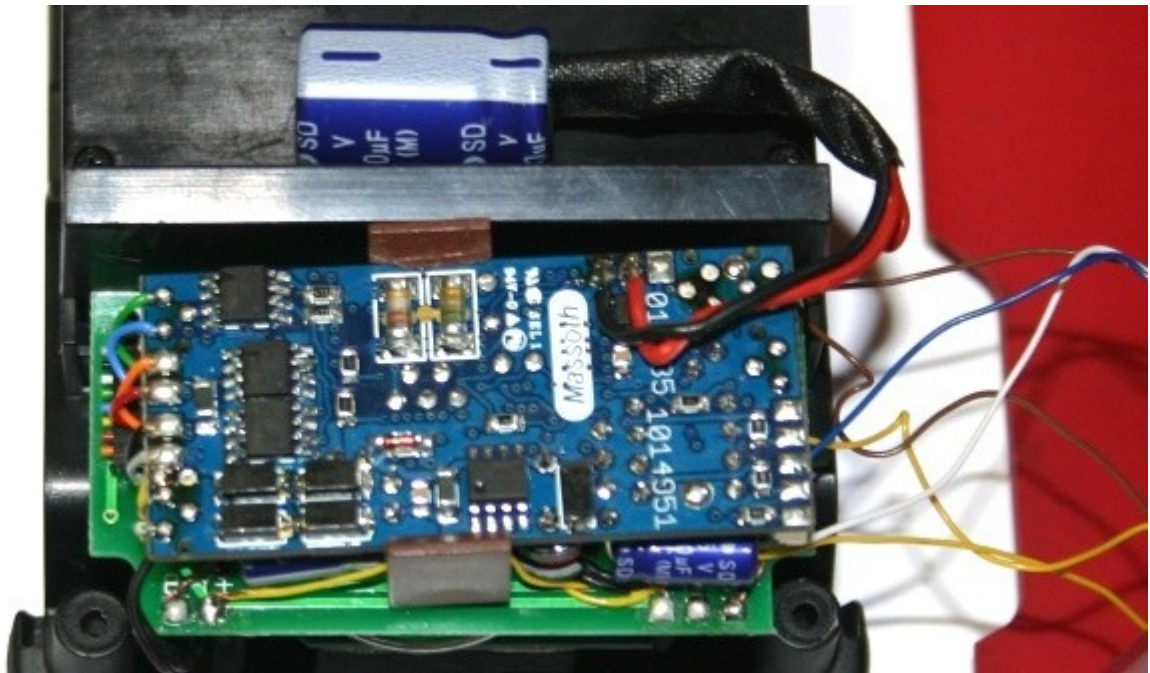
Bild-4 : Dekodereinbau mit Pufferanschluss
