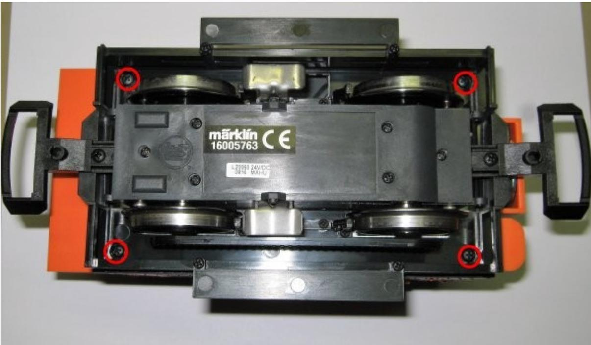
Bild-2: Öffnen des Fahrzeugs.
