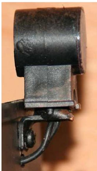
Nun bauen wir die Halter für die Prallwände. Dazu schneiden wir uns kleine Streifen aus Metall und biegen sie in die entsprechende Form. Als Material nehmen wir den Schutzschieber einer ausgedienten 3,5“-Diskette. Dieses Blech ist extrem dünn und sehr formstabil. Die fertigen Halter kleben wir an die Kante des Kohlekastens. Somit können wir später auch die Prallwände, die wir uns aus Holzleisten separat bauen, wie beim Vorbild abnehmen und so das Aussehen unsere Lok verändern.
