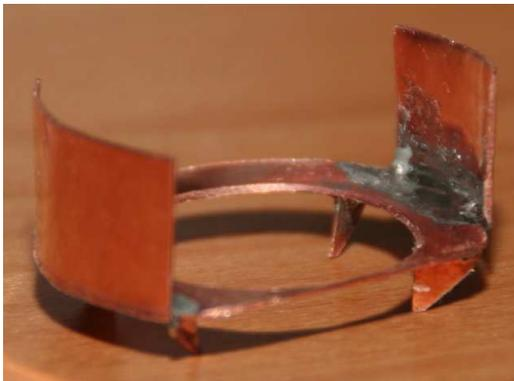
Zuerst schneiden wir uns einen Ring mit 25mm Innendurchmesser und ca. 31mm Außendurchmesser. Diesen schneiden wir gemäß der Abbildung an einer Seite flach ab.
