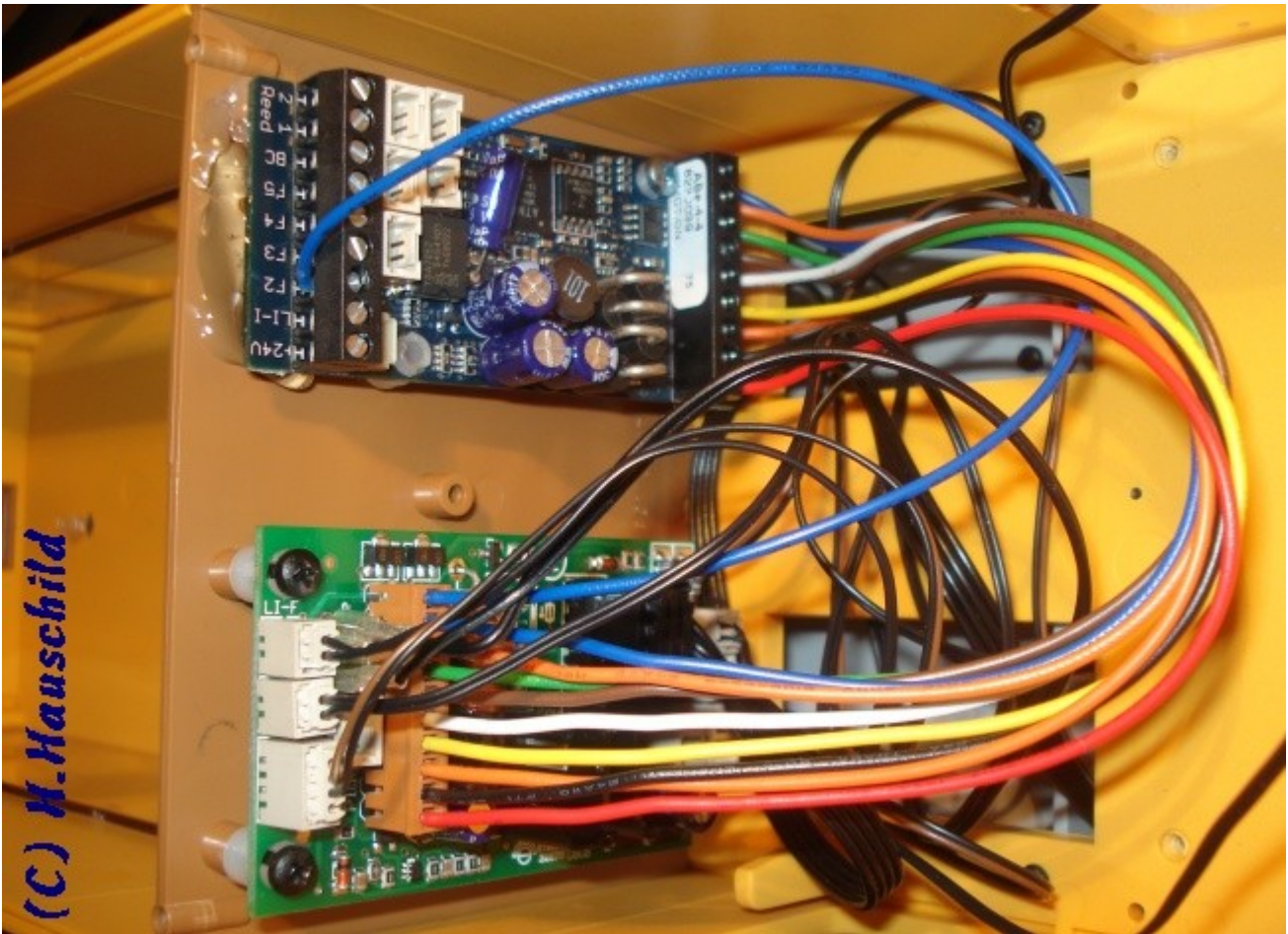
Bild-4: Einbau und Anschluss des XLS-Dekoders
