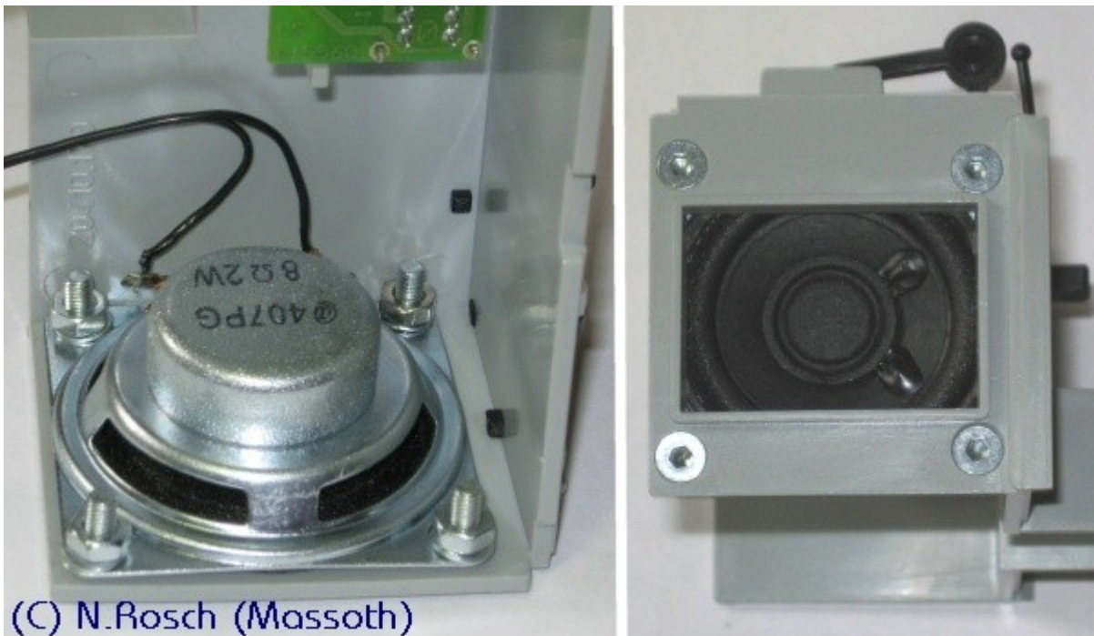
Bild-3: Einbau des Lautsprechers
