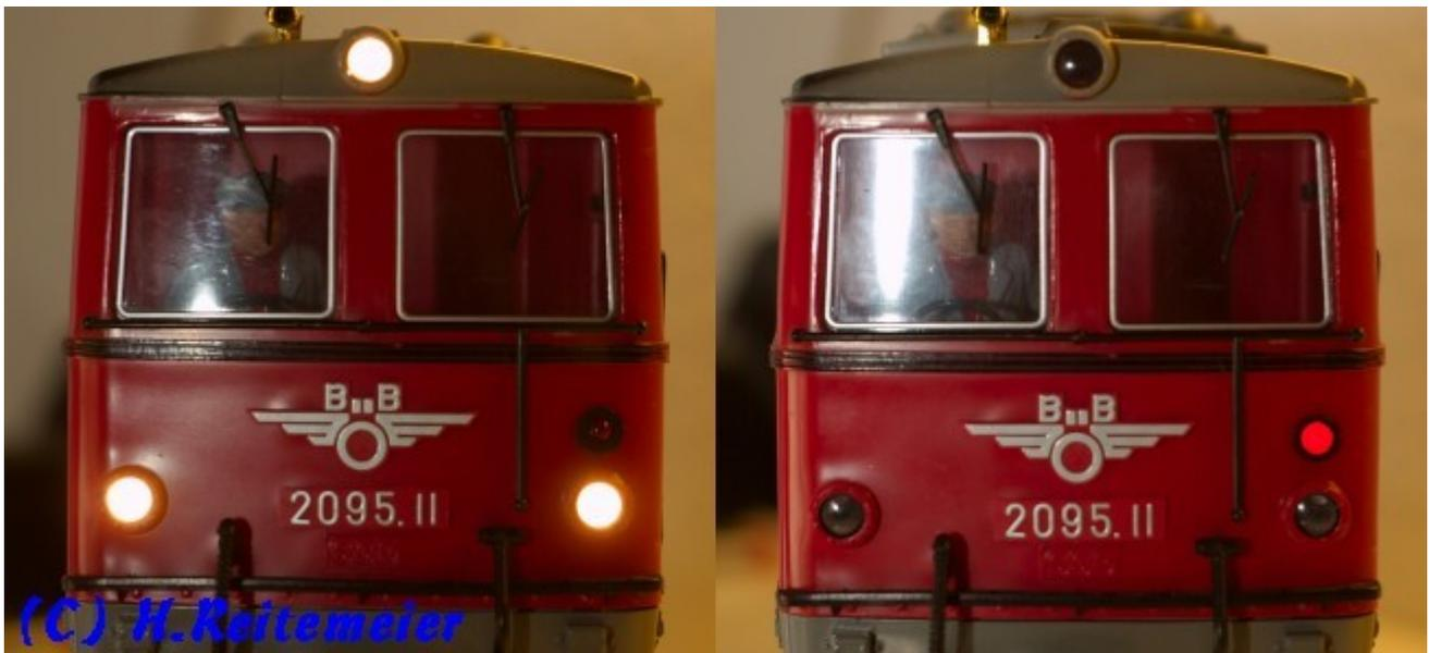
Bild-4: Umgebaute Front mit zusätzlichem Rücklicht
