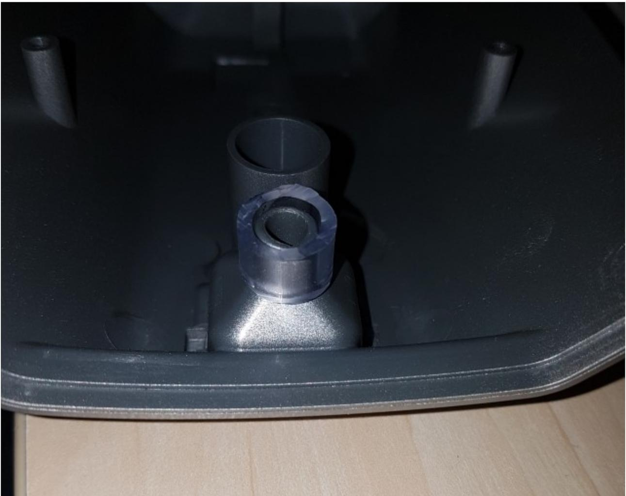
Bild 8: Verbreiterung des Abgasrohrs.
