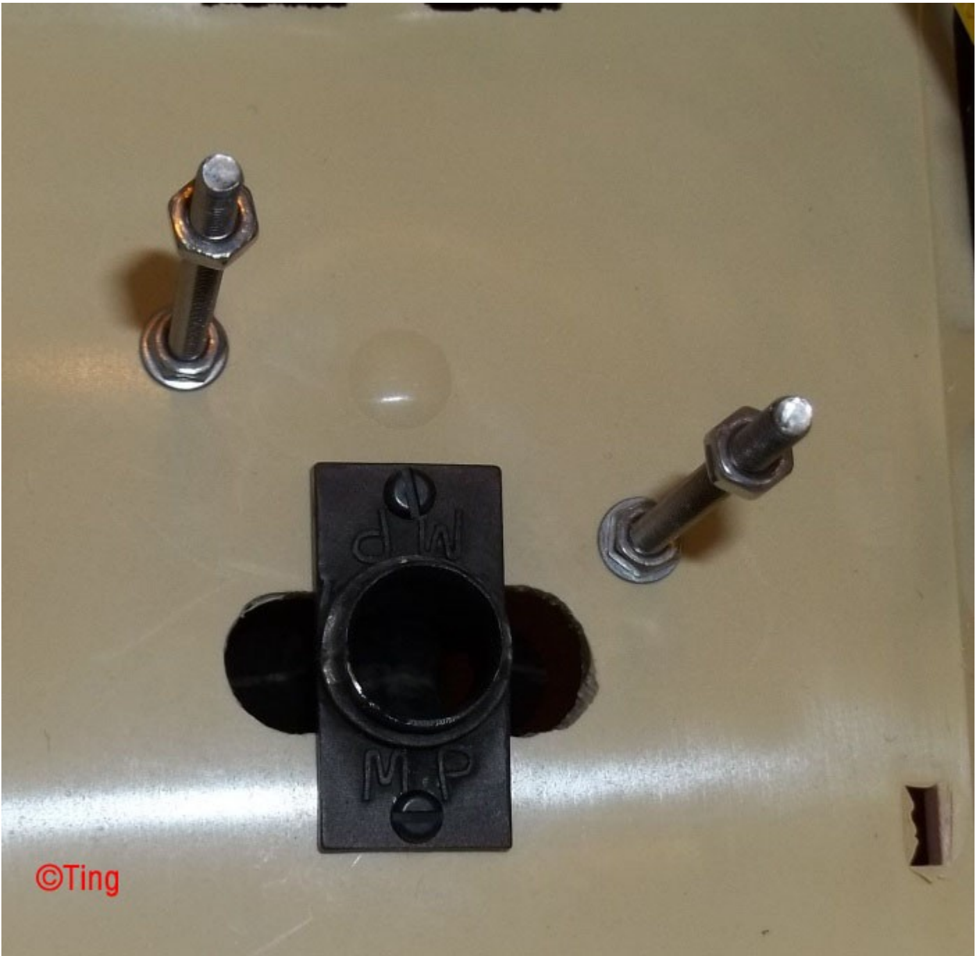
Bild 7: Y-Verteiler von unten mit 2 Befestigungsschrauben
