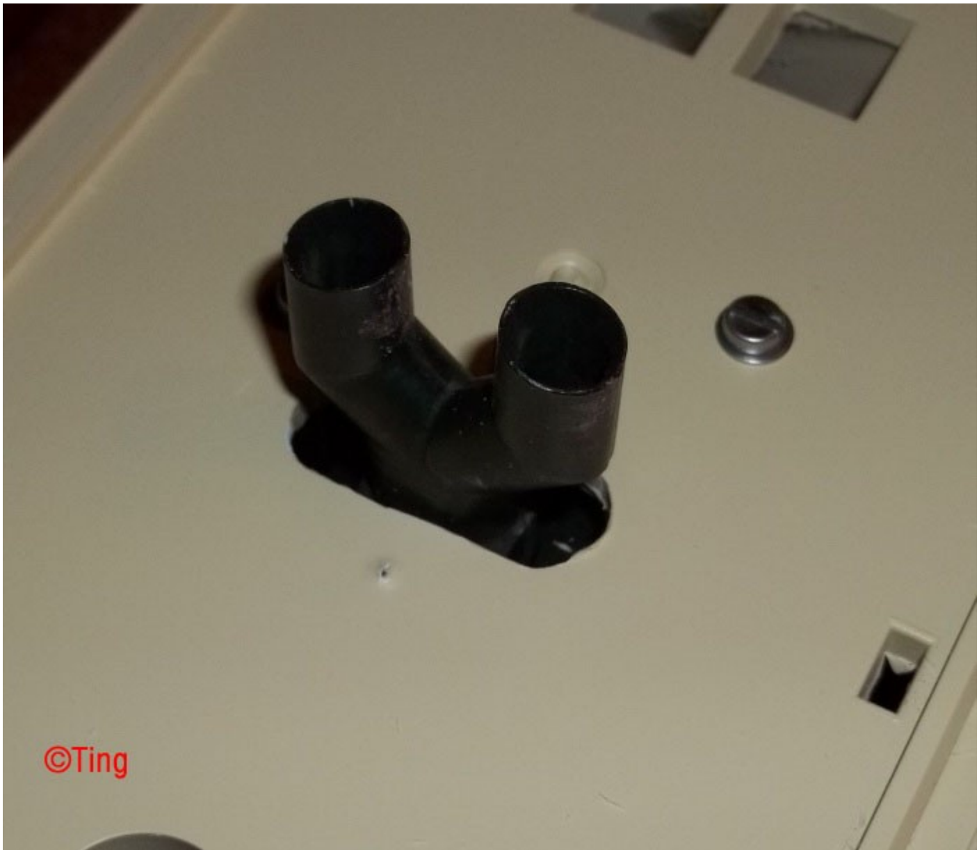
Bild 6: Y-Verteiler von oben mit 2 M3er Schrauben für Verdampfer
