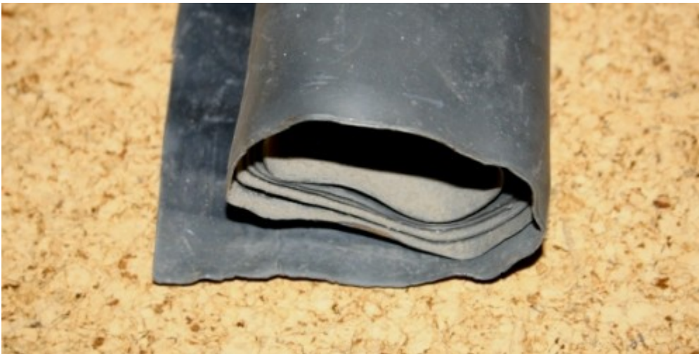
Bild-4: Restrolle Dachdeckerblei für Zusatzgewicht.
