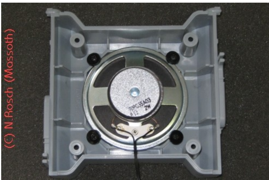
Bild-4: Montage des Lautsprechers
