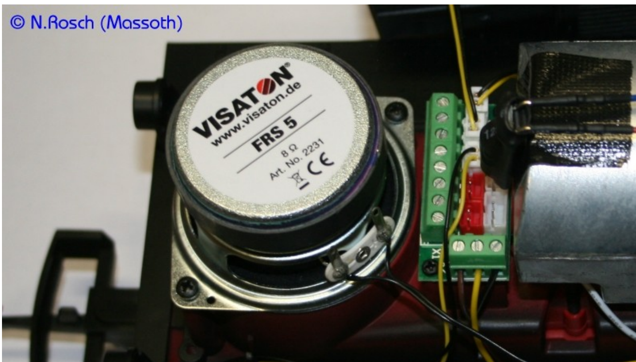
Bild-3: Montage des Lautsprechers
