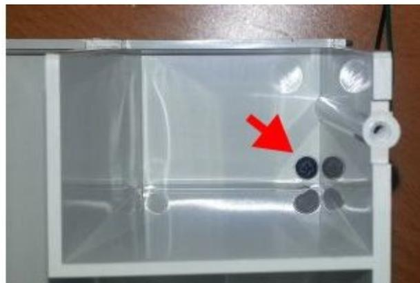
Bild 6-9: Öffnen der Schrauben für Innenteil.
