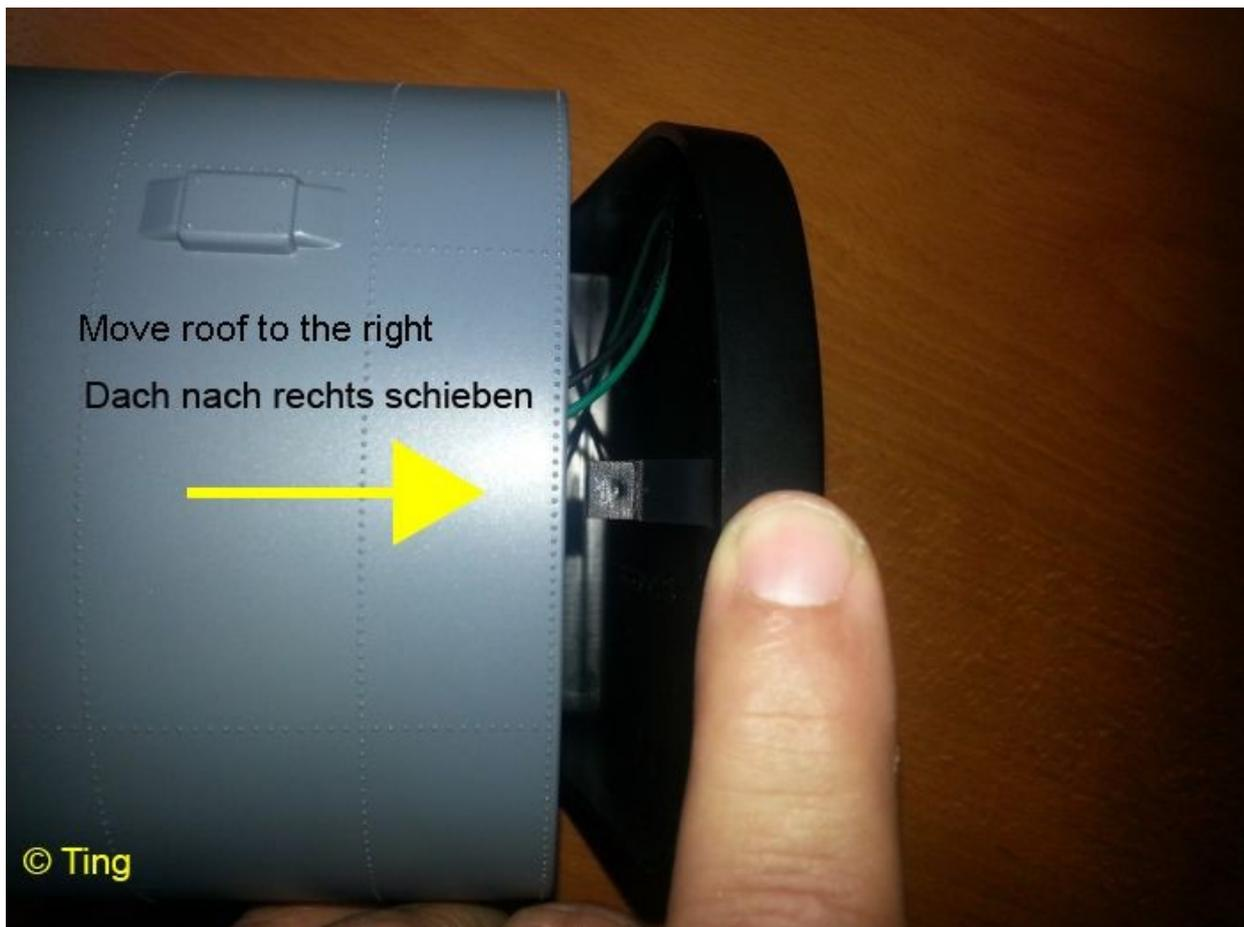
Bild 1: Demontage Dach
