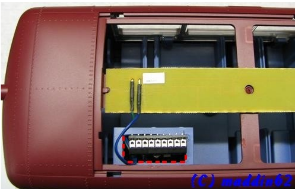
Bild-5: Dekodermontage in der Toilette und Einbau der Dachbeleuchtung.
