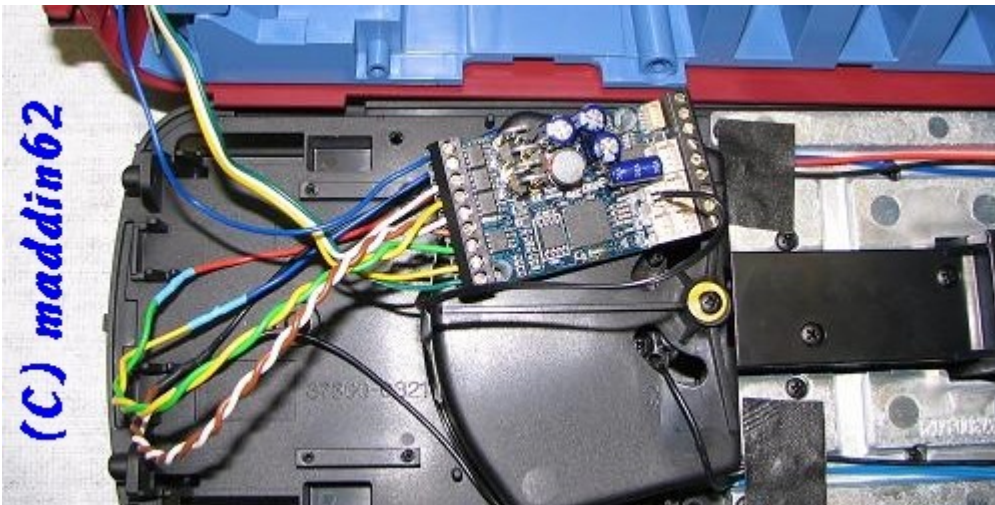
Bild-4: Fertig umverkabelte Lok
