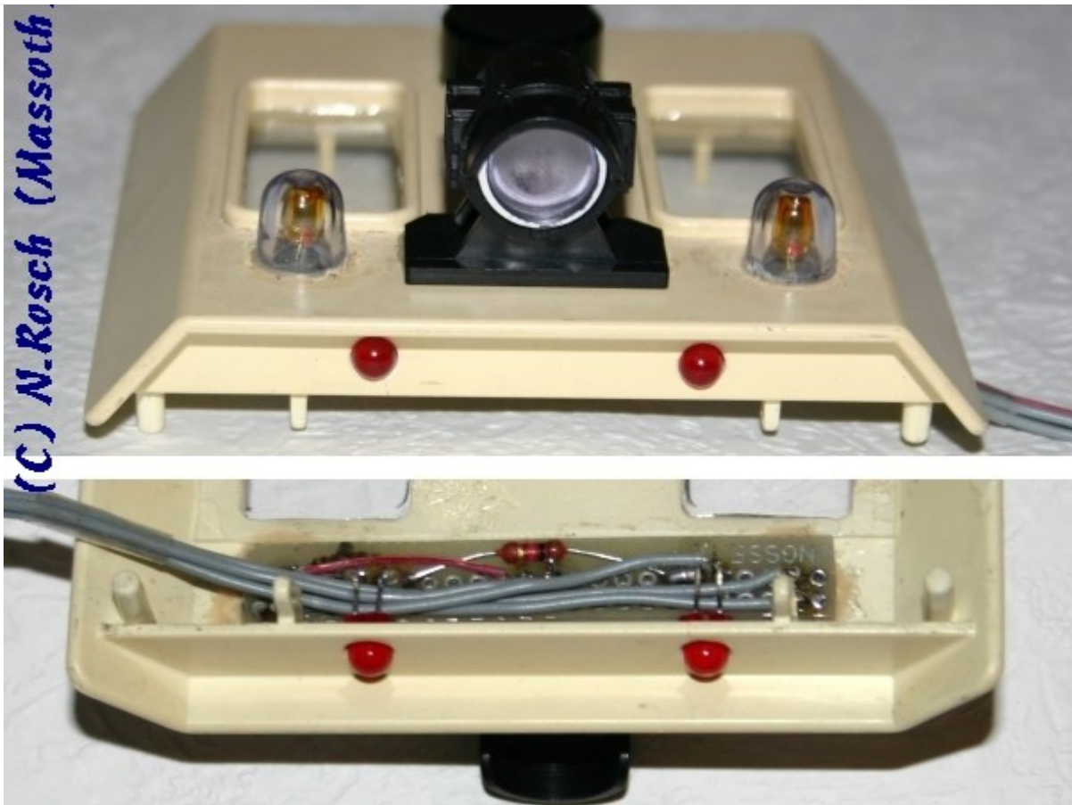
Bild-4: Zusätzliche Dachbeleuchtung.
