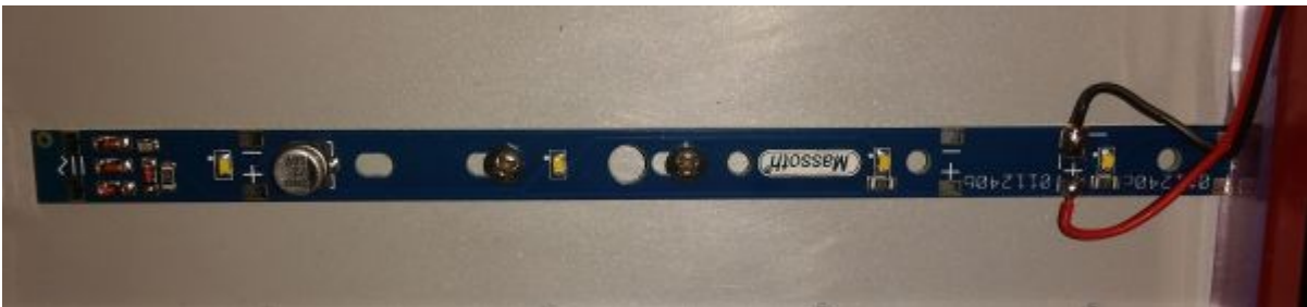
LED Leiste Teil 2, äußerer großer Teil der Lichtleiste
