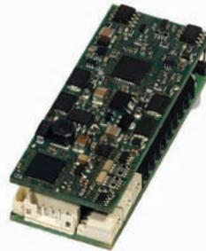
500mA ohne Hilfsspannung betreibbar). Dabei ist das ganze System sehr kompakt gebaut. Mit nur 60x25mm passen Schnittstelle und Decoder mit einer Gesamthöhe von nur 22mm auch in kleinere Lokmodelle. Sollte die Notwendigkeit bestehen, den Decoder tatsächlich einmal zu Programmierzwecken beim Händler auszubauen oder diesen aus Servicegründen zu Massoth einzuschicken, kann er unkompliziert aus der Schnittstelle genommen werden, ohne dass die Verkabelung der Lok gelöst werden muss.
