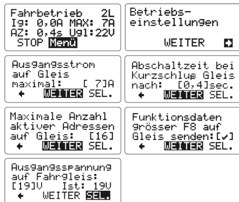
Abbildung 15: Ausgangsspannung auf Fahrgleis Illustration #15: Track Voltage
