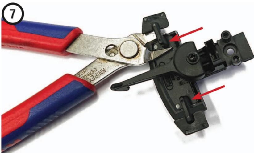
**Abbildung 7: Die Trittstufen können bei Bedarf entfernt werden**
