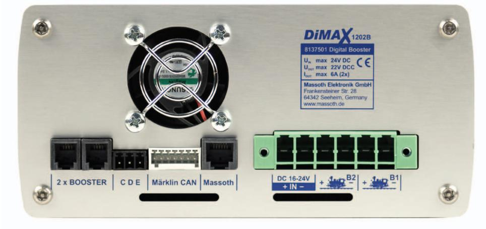
Abbildung 2: Anschlüsse auf der Rückseite des Booster 1202B
