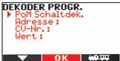
Über diesen neuen Befehl lassen sich moderne Schaltdecoder bequem direkt über das Fahrgleis programmieren. **Bei der Adresseingabe kann mit der „M1“-Taste zwischen Decodern mit Standard und erweiterten Schaltbefehlen (eS) umgeschaltet wer-**
