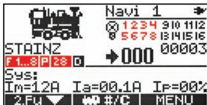
Detaillierte Funktionsangaben, Lokbild, Lokname, etc. werden in der LOK KONFIGURATION (siehe Kapitel 3.5) definiert.
