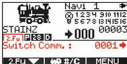
Dies funktioniert auch, wenn die Tastatur bereits wieder zur Hauptfunktion zurückgeschaltet wurde (mittels Taste F). Sie können also eine Lok in vollem Umfang steuern und dabei die letzten 8 oder 16 Weichen schalten.
