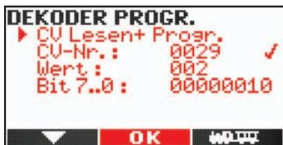
Einige CV's bestehen aus sogenannten binären Werten. Das bedeutet, dass mehrere Einstellungen in einem Wert zusammengefasst sind. Jede Funktion hat eine Bitstelle und einen Wert. Soll nun eine solche CV programmiert werden, müssen alle Wertigkeiten addiert werden. Eine deaktive Funktion hat immer
