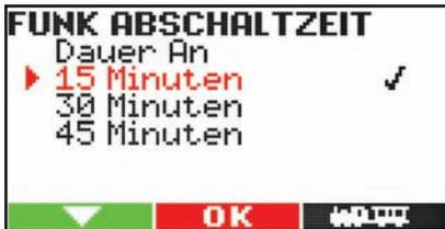
Die Funk-Abschaltzeit (Standby-Zeit) bestimmt die Dauer der Betriebszeit bei Nichtbenutzung des Navigators, bis sich der Handregler automatisch abmeldet und ausschaltet. Bei Abschalten oder Empfangsverlust werden automatisch alle zugewiesenen Loks abgemeldet.
