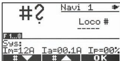
Nun kann die Lokomotive bereits mit dem Drehregler gesteuert werden. Der erste Fahrbetrieb ist sofort möglich. Die Lokomotive erhält ihre Fahrdaten mit 28 Fahrstufen und parallelen Funktionsdaten.
