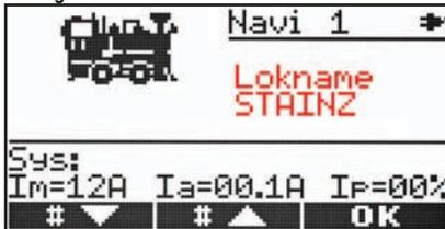
Hier definieren Sie Ihre persönlich bevorzugte Lokbezeichnung, die im Fahrbetrieb unterhalb des Loksymbolen angezeigt wird. Auch bei Nutzung der zweiten Lokfahrfunktion wird der Lokname angezeigt. Hierbei steht der Lokname unterhalb der Lokadresse. Drücken Sie die Tasten **M1** und **M2** oder drehen Sie langsam den Drehknopf um durch die verfügbaren Zeichen
