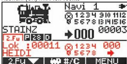
Die gewünschte Lok muss konfiguriert sein. Um in diesen Modus zu gelangen, drücken Sie so oft **M1** bis die Anzeige im Nebenfunktionsfeld Lok: XXX anzeigt. Geben Sie nun die Lokadresse über die Tastatur ein oder wählen über die runde Taste aus und bestätigen Sie Ihre Wahl anschließend mit der rechten Pfeil-Taste der zweiten Funktion. Mit der zweiten Lokfunktion können nur konfigurierte und gespeicherte Loks geladen werden. **Die freie Eingabe einer neuen unbekanntem Lok ist nicht möglich.**
