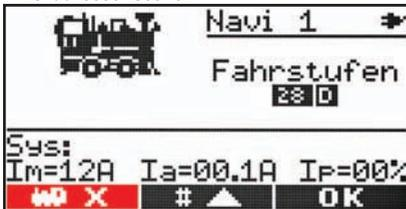
Durch langes Drücken der Taste **M2** gelangen Sie in das Lok Konfigurationsmenü. Im ersten Konfigurationsfenster haben Sie die Möglichkeit eine nicht mehr benötigte Lok zu löschen. Durch Drücken von **M1** wird die aktuelle Lok gelöscht. Nun müssen Sie mit **M1** oder **M2** wieder eine neue Lok auswählen und mit **M3** bestätigen.
