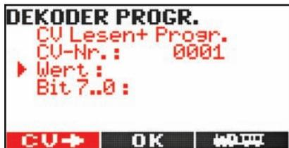
Die CV Programmierung ist heute die wohl einfachste und üblichste Programmiervariante, die von nahezu allen Digitalsystemen unterstützt wird. Dabei wird beim Programmierverfahren die zu programmierende CV und der Programmierwert eingegeben und mit **M2** programmiert. Die Programmierung erfolgt abhängig vom Digitalsystem auf einem separaten Programmiergleis oder auf dem Fahrgleis, das als Programmiergleis genutzt wird (Details hierzu finden Sie in der Anleitung Ihrer Digitalzentrale).
