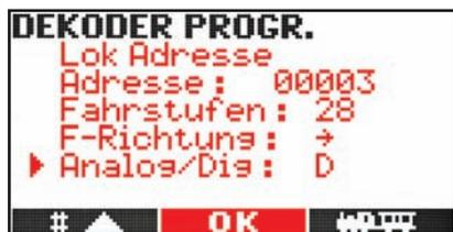
Hier wird die Lokadresse der Lok ausgelesen und programmiert. Die Adresse ist wählbar von 1-10239. Der Navigator berechnet automatisch die passenden Programmierwerte für CV 1, 17 und 18 + 29. Zusätzlich können Sie noch angeben ob der Decoder mit 14 oder 28 Fahrstufen betrieben werden soll, die Fahrtrichtung festlegen und den Analogbetrieb sperren.
