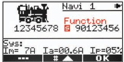
Bei der Wahl der Funktionsdatenübertragung kann mit der Taste **M2** zwischen parallel **P** und seriell **S** gewählt werden. Bestätigen Sie Ihre Wahl anschließend mit **M3** wenn Sie nicht auch noch die F-Tasten konfigurieren möchten. Üblicherweise werden alle DCC-Decoder im „P“-Modus gestartet. Einige ältere LGB-Soundloks benötigen die spezielle „serielle Pulschette“.
