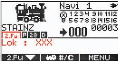
Der DiMAX Navigator bietet die Möglichkeit, zwei Lokomotiven bzw. Züge gleichzeitig und unabhängig voneinander zu steuern. Die Bedienung einer Lok in der 2. Funktionsebene unterscheidet sich in folgenden Punkten:
