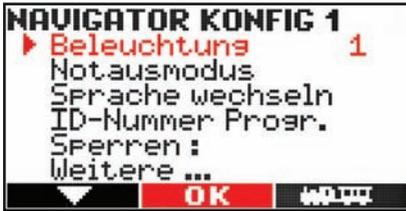
Schalten Sie mit diesem Menüpunkt die Beleuchtung des DiMAX Navigators. Folgende Einstellungen sind mittels Taste M2 möglich:
