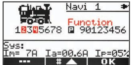
Sie haben die Möglichkeit die Funktionen 1-16 auf Moment- oder Dauerbetrieb zu konfigurieren. Um die Tasten 9-16 auszuwählen drücken Sie einmal die **F-Taste**. Sind die Zahlen 1-16 im Display nicht invers abgebildet, so arbeiten die Tasten wie üblich (1 x Drücken entspricht 1 x
