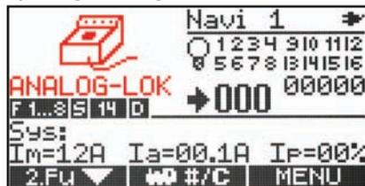
Natürlich kann auch eine analoge Lok mit dem DiMAX Navigator gesteuert werden. Die Adresse einer analogen Lokomotive ist „0“. Die Definition der Lokeigenschaften, wie zum Beispiel Fahr-
