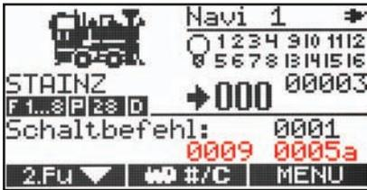
Mit der aktivierten Rückmeldeanzeige (über Spezialmodus B3) ist es möglich, die ausgelösten Gleiskontakte der Rückmeldemodule im Navigator anzuzeigen zu lassen. In der 2. Funktionsebene unter Schaltbefehl werden die Kontaktnummern in der unteren Zeile dargestellt. Vorne sehen sie die umgerechnete Kontakt Nummer, wie sie bei der PC-Steuerung verarbeitet wird. Hinten steht die programmierte Kontakt Nummer.
