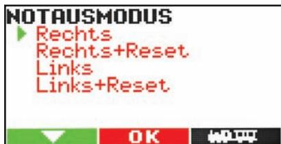
Wählen Sie in diesem Menüpunkt den bevorzugten Notausmodus, zum Beispiel abhängig davon, ob Sie Links- oder Rechtshänder sind. Mit LINKS und RECHTS definieren Sie die Taste zum Auslösen eines NOTAUS. Mit der zweiten STOP-Taste heben Sie den NOTAUS wieder auf. Die Option RESET erlaubt zusätzlich das Senden eines RESET-Befehls. Es werden alle Loks angehalten, jedoch wird die Fahrspannung nicht ausgeschaltet. Beim Massoth System werden auch gepufferte Loks durch NOTAUS immer angehalten.
