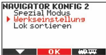
Bestätigen Sie das Rücksetzen des DiMAX Navigators auf die Werkeinstellung nur, wenn Sie sich sicher sind. Ansonsten verlassen Sie diesen Menüpunkt mit **M3**. Sonst werden alle konfigurierten Einträge des Navigators gelöscht. Anschließend befindet sich der DiMAX Navigator wieder im Auslieferungszustand. Es müssen dann alle programmierten Einträge (z.B. Loks, Fahrstraßen, Traktionen, Weichen, ...) neu angelegt werden. Der Navigator wird anschließend neu gestartet.
