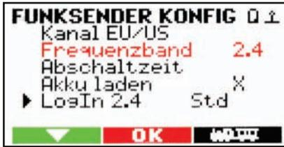
Mit dem fest integrierten 2.4GHz Funkchip kann nur das 2.4GHz Frequenzband genutzt werden. Die Firmware unterstützt auch noch die EU/US Frequenzbänder, die hier aber keine Auswirkung haben. Eine Auswahl der falschen Frequenzbänder führt nur zum Abschalten des Funksystems. (siehe auch Kapitel **LogIn 2.4GHz**)
