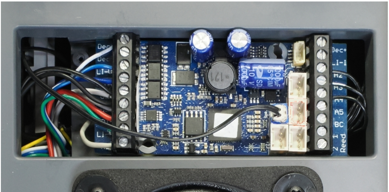
Bild 4 : Anschluss und Montage des XLS-Dekoders
