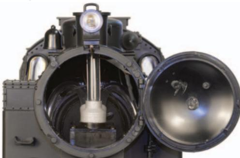
Abbildung 3: LGB 2080 mit eingebautem gepulsten Verdampfer und Zylinderdampfmodul.
