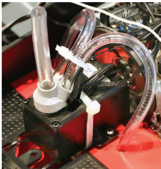
Abbildung 1: Gepulster Verdampfer mit montiertem Zylinderdampfmodul in einer LGB 2080.
