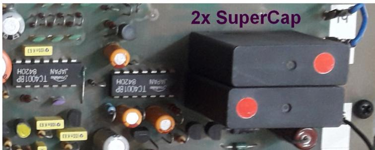
Dies ist ein Beispiel aus der LGB Lok 2096S von 1983. Die beiden Puffer hatten eine Kapazität von 8 Wattsekunden. Das sind 40% des Powercap 200 bei 4x so großem Volumen. Seitdem hat sich die Technik stark geändert, die Kondensatoren wurden kleiner bei gleichzeitig höherer Kapazität und Strombelastbarkeit.
