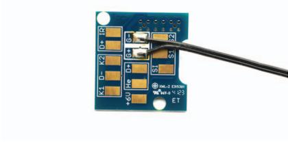
**Anschlussplatine Weichenantrieb EVO-X (300mm)**
