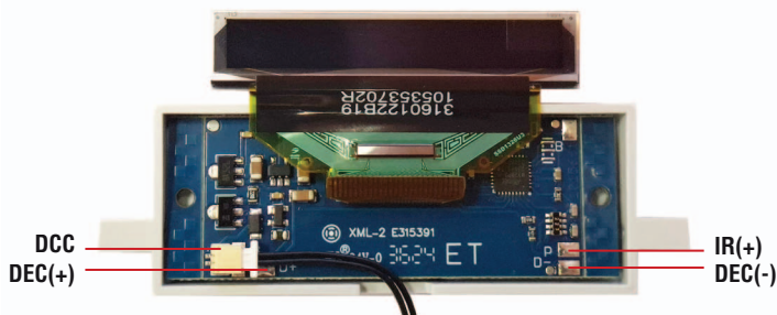
Abbildung 5: Pinbelegung Displayplatine (nur für erfahrene Anwender)
